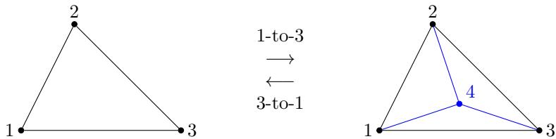
Potez 1-u-3 u dati trougao dodaje nov verteks, spaja ga sa postojećim verteksima, i iseca početni trougao na tri manja. Potez 3-u-1 vrši inverznu operaciju.
