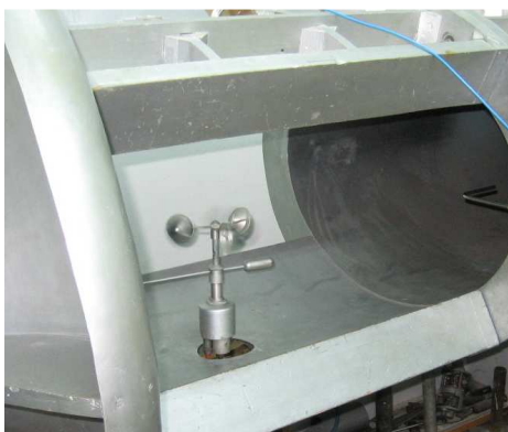
Слика 4. Положај анемометра унутар радне - тест секције аеро-тунела.
