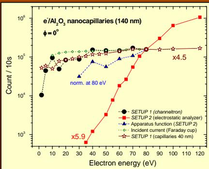
Intenzitet struje elektrona propuštenih kroz  $\text{Al}_2\text{O}_3$  nanokapilare u pravcu upadnog mlaza (tilt ugao  $0^\circ$ ) u funkciji upadne energije. (SPEPRA) [6]
