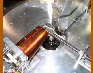
• Visoke energije (100-350 eV), Promena tilt ugla i ugla observacije, Energijska analiza transmitovanih elektrona, Rezolucija upadnog mlaza  $\approx 0.5$  eV, pritisak u komori  $3 \times 10^{-7}$  mbar.
