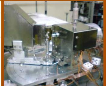
• Niske energije (0-120 eV), Promena samo tilt ugla, Mogućnost kako integralne detekcije detekcije (SET-UP 1) tako i detekcije elektrona selektivanih po energiji (SET-UP 2), Visoka rezolucija upadnog mlaza  $\approx 0.05$  eV, pritisak  $2 \times 10^{-7}$  mbar.
