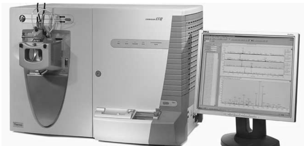
Слика 4. Масени спектрометар „LTQ XL - Thermo SCIENTIFIC“
