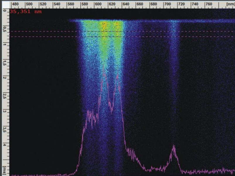
Luminescentni emisijski spekter  $\text{Eu}^{3+}$  dopanega  $\text{Gd}_2\text{Zr}_2\text{O}_7$  OPO je pri 360 nm.
